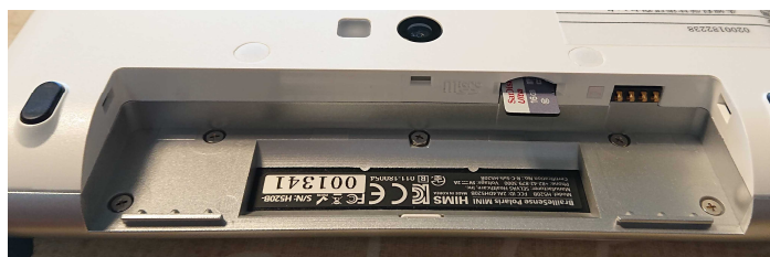
画像：ポラリスミニのバッテリーを外し、microSD カードを差し込んでいる写真
