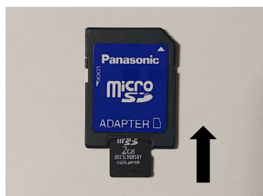
画像：microSD カードのアダプタ に microSD カードのアダプタを挿 入している写真
