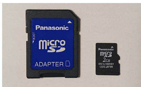
画像：microSD カード（右）と microSD カードのアダプタ（左）
