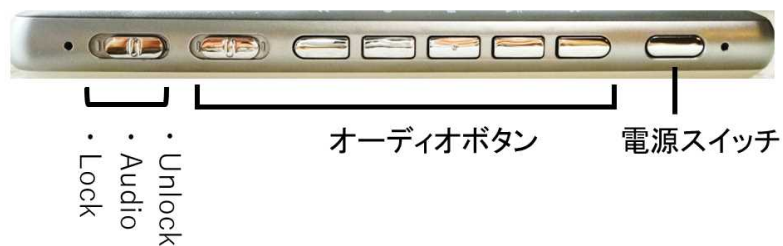
画像：ポラリスミニ前面の電源スイッチとキーロックスイッチ
