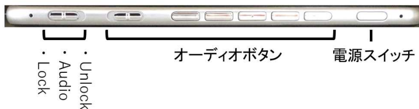
画像：ポラリス前面の電源スイッチとキーロックスイッチ
